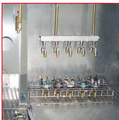
Esempio 2: Sistema di pulizia per gli ugelli degli aerografi
