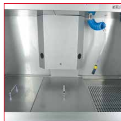
Esempio 4: Vasche ad immersione e copertura perforata
