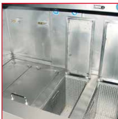
Esempio 3: Vasche ad immersione con cestelli
