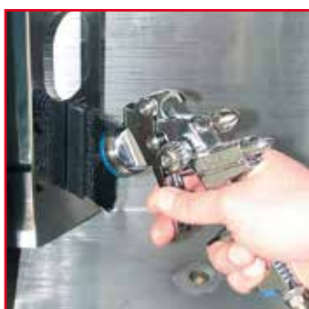
Pulizia ad aria con striscia di spazzola [ air cap cleaning with strip ]
